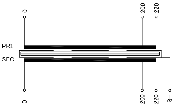
回路図 Circuit Diagram
